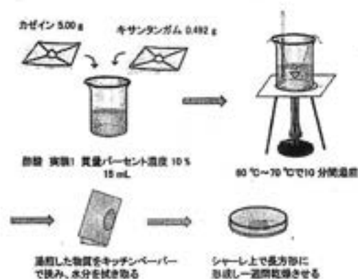
図1 実験1におけるカゼインプラスチックの合成方法 図2 実験1における耐久性の測定方法
