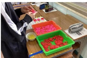
シャボン玉に必要なストローですが、写真のストローはカニの形をした物で、カニの表面、裏面、ストローの3つの部品を組み立てる必要があります。力を入れすぎるとカニの部分にひびが入ってしまったり、ストローが裂けてしまったりして、製品として成立しなくなるため、慎重かつ丁寧に作業することが求められます。
