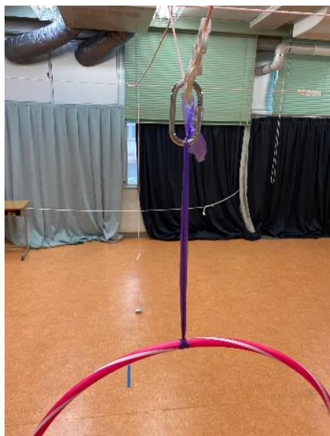
←天井にマス目状にロープを張って、探索活動に使うフラフープやタンバリンなどを吊り下げられるようになっています。ロープに吊り下げる道具にカラビナを取り付け、簡単に着脱できるようになっています。
